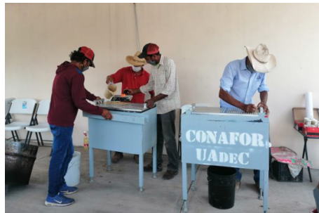
Figura 7. Proceso de moldeado de la cera de candelilla para obtención de presentaciones comerciales finales
