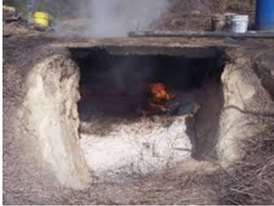
Figura 5. Pailas tradicionales de extracción de cera de candelilla
